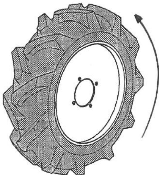
Die Reifenrichtung des Profils sollte wie auf dem Bild sein
