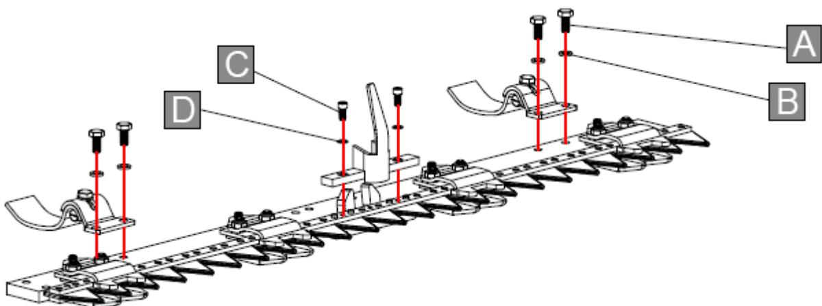
Montieren Sie die Schwenkblockbaugruppe und den Höheneinstellblock
