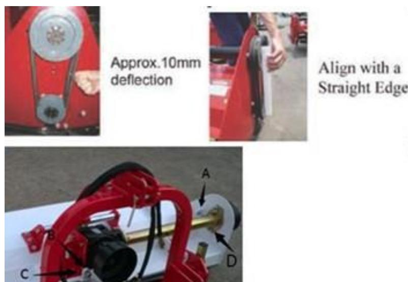
Lösen Sie die Schrauben A, B und C. Spannen Sie die Riemen mit den Schrauben A und B
