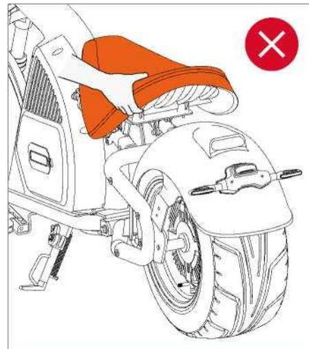
Bitte bewegen Sie das Motorrad, indem Sie den Rahmen mit einer Hand festhalten, wie in der Abbildung oben gezeigt. 2. Weiche Materialien können sich unter der Einwirkung starker Kräfte verformen oder beschädigt werden. Wenden Sie daher beim Umgang mit dem Motorrad oder beim Bewegen desselben keine starken Kräfte an.
