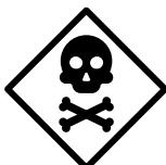
**GEFAHR:** Weist auf eine unmittelbare Gefahrensituation hin, die, wenn sie nicht vermieden wird, zu schweren Verletzungen oder zum Tod führen kann. Das Signalwort gilt nur für die extremsten Situationen, typischerweise für Maschinenteile, die aus funktionalen Gründen nicht geschützt werden können.
